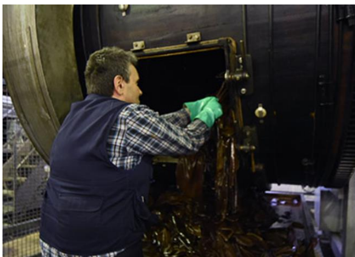
Operaio impegnato nell'estrazione delle pelli dal bottale
